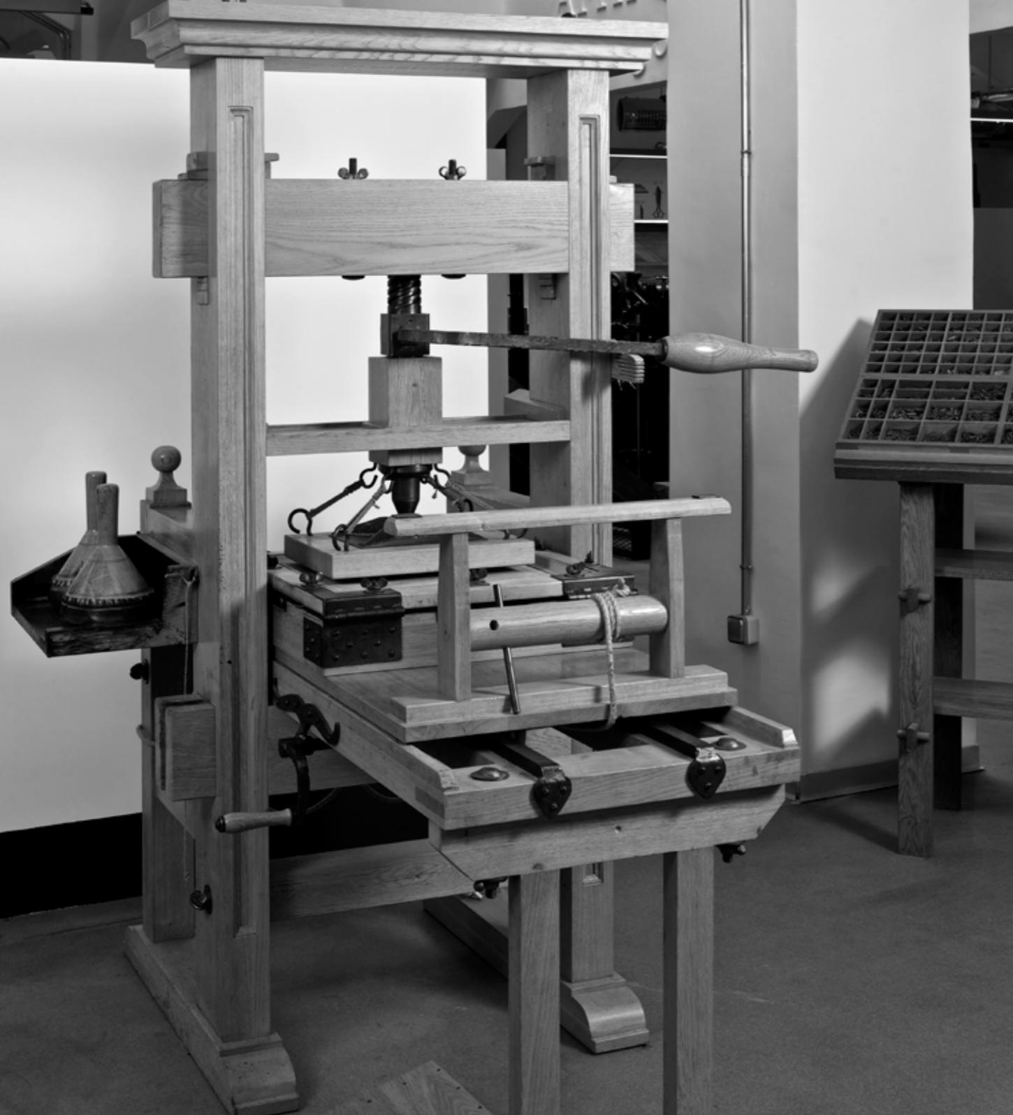
2 Tórculo: tipo de prensa utilizada para la impresión de grabados en metal o calcografías.
